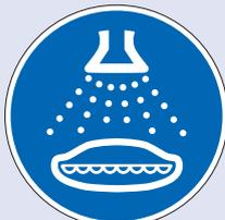
Wassersprühanlage einschalten beim Aussetzvorgang
