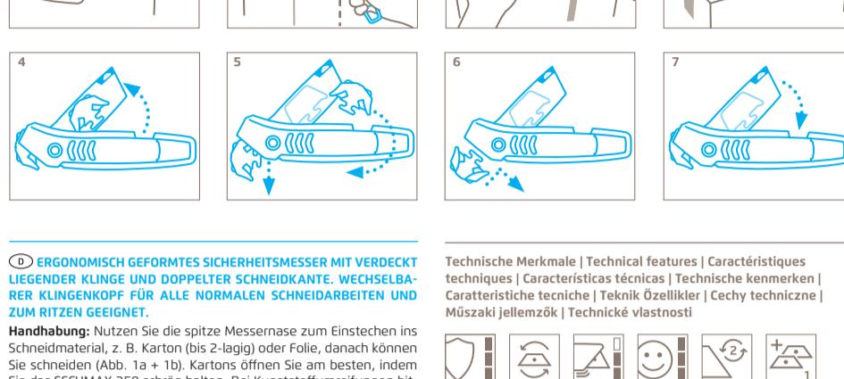
**D ERGONOMISCH GEFORMTES SICHERHEITSMESER MIT VERDECKT LIEGENDER KLINGE UND DOPPELTER SCHNEIDKANTE. WECHSELBARER KLINGENKOPF FÜR ALLE NORMALEN SCHNEIDARBEITEN UND ZUM RITZEN EIGENET.**
