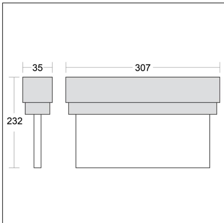
LED-Scheibenleuchte für universelle Montage (Wand-/Deckenaufbau), als Einzelbatterie -Notleuchte mit manueller Testfunktion, Signalisierung über 1x mehrfarbige LED, inklusive Prüftaster, gemäß DIN EN 60598-1, DIN EN 60598-2-22 und DIN EN 1838 für Anlagen gemäß DIN VDE 0108 / 10.89 zum separaten Betrieb.
