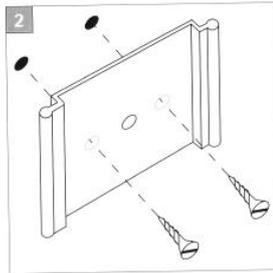
Die Montageplatte kann mit einer (mittige Bohrung) oder zwei Schrauben\* an der Wand befestigt werden. Zur Montageunterstützung ist das Schild rückseitig selbstklebend ausgerüstet.
