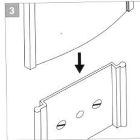
Nach dem Anbringen der Montageplatte wird das eigentliche Schild wieder aufgesetzt.
