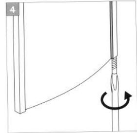
Mit dem Arretieren des Schildes durch die Sicherungsschraube ist die Montage abgeschlossen.
