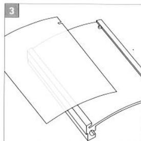
Nach Einlage des Papiers die Abdeckhaube zunächst rechts in den Sicherungsstift setzen, um auch hier die richtige Position zu finden und eine unberechtigte Entnahme zu verhindern.
