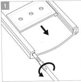
Zur Entnahme der Montageplatte die untere Sicherungsschraube öffnen.
