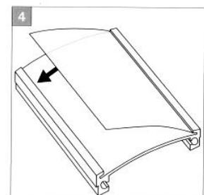
Nun wird das Türschild geschlossen, indem Sie die Abdeckhaube an der linken Seite in das Profil einschieben.
