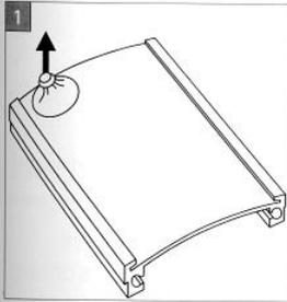
Die PVC-Haube entnehmen Sie, indem Sie den beiliegenden Sauger auf die Scheibe pressen und anschließend die Haube nach vorne abziehen.
