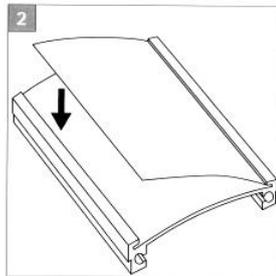
Beachten Sie beim Einlegen der Beschriftung, dass die Stanzung in der Papiervorlage oben rechts in den Sicherungsstift des Schildes eingepasst wird. Richtige Position und Schutz vor unbefugter Entnahme ist so garantiert.
