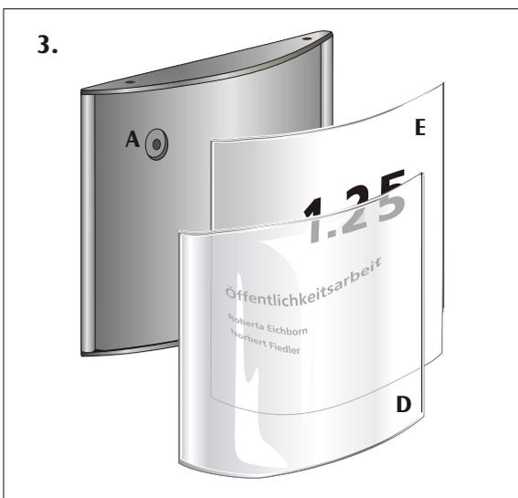
3. Durch Zusammendrücken der Papiereinlage **E** und Abdeckung **D** Spannung erzeugen und in das Profil **A** gleiten lassen.
