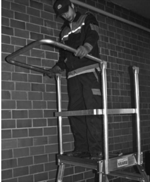
Die Knieleiste montieren und das Geländer von hinten aufschieben. Die Geländerpfosten ausrichten und fest verschrauben. Die Geländerverbinder sind fest anzuziehen (20 Nm).
