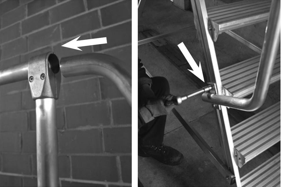
Zur Montage ist das obere Ende des Handlaufs ebenfalls bis zur Hälfte in die vorderen Geländerverbinder einzuführen. Anschließend die untere Befestigung des Handlaufs und die Geländerverbinder fest anziehen (20 Nm).
