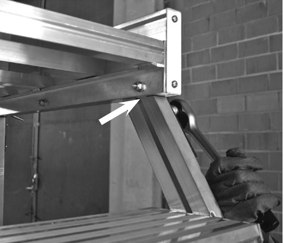
Die Podestleiter ist vertikal und horizontal exakt auszurichten, das Steig-/ und Stützteil müssen vollflächig am Podest aufliegen (siehe Pfeil). Die Schraubverbindungen sind anschließend fest zu verschrauben (20 Nm).
