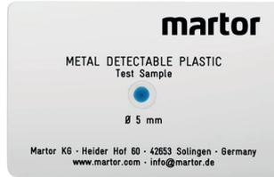
Mit den Acrylkarten überprüfen Sie die Sensibilität Ihrer Detektoren für metalledetektierbare Kunststoffe. Das MDP-PRÜFKARTENSET ACRYL besteht aus fünf Karten. Diese tragen als „Fremdkörper“ je eine Kunststoffkugel in sich – zwischen 2,5 mm und 8 mm stark. Die Acrylkarten sind besonders stabil und langlebig.
