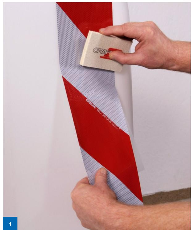
Abbildung 1. Aufbringen des Materials auf die Oberfläche.
