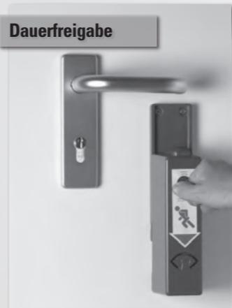
Mit dem Geräteschlüssel kann der Türwächter durch Verschieben nach unten alarmfrei in eine Dauerfreigabeposition gebracht werden. In dieser Position ist die Tür normal begehbar. Ein Daueroffenkontakt ist auf Wunsch möglich.
