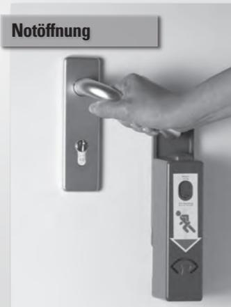
Beim Durchdrücken der Türklinke verschiebt sich der EH-Türwächter automatisch nach unten und ermöglicht mit nur einem Handgriff das Begehen der Notausgangstür. Dabei wird Daueralarm ausgelöst, der nur mit dem Geräteschlüssel gelöscht werden kann.
