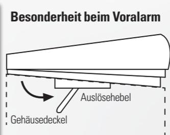
Wenn der Gehäusedeckel geschlossen wird, muss der Auslösehebel des Voralarms komplett ausgeklappt sein.
