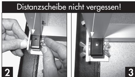
Sichern Sie alles mittels der Flügelmutter und ziehen Sie diese fest an (Bild 2+3). Danach ziehen Sie bitte die Flügelschraube mit selbstsichernder Mutter nochmals nach.
