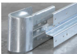
Nun das Kopfstück mit den runden Löchern an der HINTEREN Seite des vorderen Plankenendes auflegen und montieren (gemäß Straßenverlauf).
