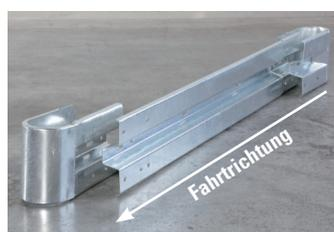
Planke so ausrichten, dass das Plankenende mit runden Löchern gemäß des Straßenverlaufs vorne und das Plankenende mit tropfenförmigen Löchern hinten liegt.
