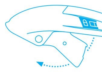
Danach drehen Sie den **Hebel aus dem Griff** heraus und öffnen Sie die Klinsenabdeckung.
