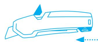
Fixieren Sie den Hebel mit der Sicherung und drehen Sie den Griff so, dass die **transparente Klingendeckung nach oben** zeigt.
