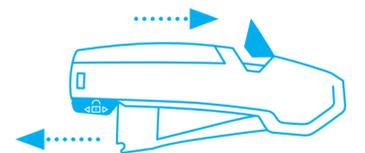
Schieben Sie die Sicherung in die hintere Position, damit sich der **Hebel wieder lösen** kann. **Danach** Klingenswechselschalter in den Griff zurückdrücken und weiterschneiden.
