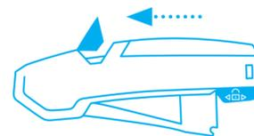
Ziehen Sie den **Klingenwechselschalter** nach oben heraus und betätigen Sie den Hebel. Klinge und Klingenträger treten aus dem Griff heraus.
