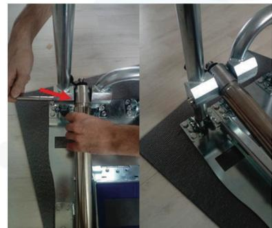
Abbildung 33 - Einsetzen des Sicherungsbolzen
