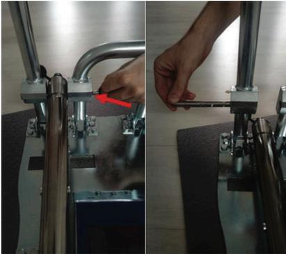
Abbildung 34 - Sicherungsbolzen entfernen
