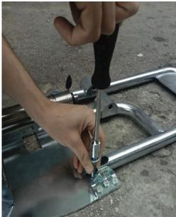
Befestigen Sie den Parkbügel, d.H. Ziehen Sie die Dübel mit dem Steckschlüssel der Größe 13 fest.
