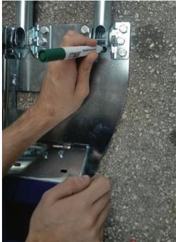
Markieren Sie die vier Stellen, die gebohrt werden müssen. Es wird empfohlen, die Bodenplatte [Abbildung 2 - Innenraum des Parkbügels] als Vorlage zu verwenden.
