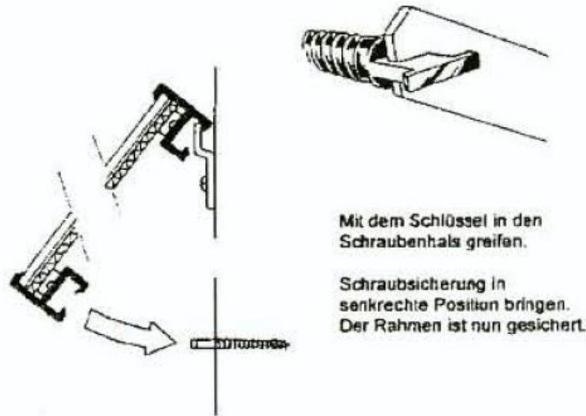
Schraubsicherung in waagerechte Position bringen.
