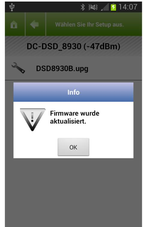
**Während des Upgrade Prozesses darf das Gerät nicht von der Energieversorgung getrennt werden! Die max. Entfernung zwischen Smartphone und DSD, bei Sichtkontakt, beträgt 50m.**
