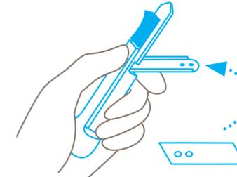
Mithilfe des Zeigefingers Klingenhaltung langsam **nach unten aufklappen**, Klinge mit der anderen Hand entnehmen und wenden (für Linkshänder) oder wechseln.
