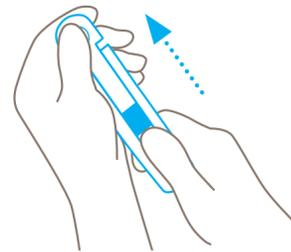
**Drücken** Sie den Kunststoffeinsatz mithilfe des Schiebers nach hinten heraus. **Nicht** am Einsatz ziehen und gleichzeitig den Schieber festhalten.
